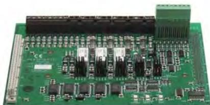
Как 772479, но с дополнительным слотом для подключения микромодуля. Карта внешних устройств может быть подключена только разъёму №1 базовой карты КП.
