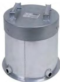
Рекомендуется использовать защитный кожух при установке измерительной камеры 781443 вне помещений, или на не отапливаемых чердаках для предотвращения образования конденсата. Установочное кольцо и кожух могут быть смонтированы на уже установленных измерительных камерах. Крышка кожуха легко снимается для проведения проверки и обслуживания системы.
