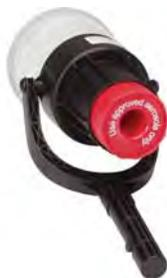
Тестер предназначен для проверки дымовых извещателей серий IQ8Quad и ES Detect. Работоспособность измерительной камеры и цепей обработки сигнала проверяется впрыскиванием тестового аэрозоля. Тестер крепится на телескопическую штангу (арт.№ 060427).
