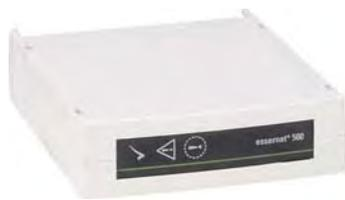
Сетевой модуль для создания сети essernet до 31 абонента. Протокол: аналоговый DIN 19245 - 1 (Profibus). Топология: кольцевая, устойчивая к обрыву и короткому замыканию. Пластиковый корпус с наглядной светодиодной индикацией состояний.
