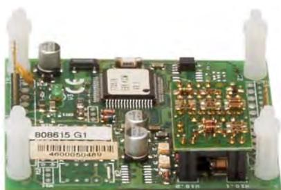
Транспондер обеспечивает интеграцию панели пожаротушения 8010 в кольцевой шлейф пожарных панелей серии 8000 или IQ8Control, позволяя объединять в сеть несколько зон тушения. На каждый кольцевой шлейф можно подключить до 8 панелей 8010. Все индикаторы и выходы могут активизироваться по команде пожарных панелей. Транспондер занимает один адрес на шлейфе.
