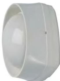
Адресное сигнальное устройство с питанием от шлейфа, соответствующее нормам EN 54-3. 19 программируемых тональных сигналов, включая DIN-тоны (по DIN 33404 часть 3). Громкость может быть выставлена по 8 уровням. Плоский корпус позволяет оптимально адаптировать устройство под дизайн помещения. Корпус выполнен из ударопрочного пластика, устойчивого к царапинам. При использовании баз 806201 и 806202, может быть обеспечена защита от воздействия окружающей среды.
