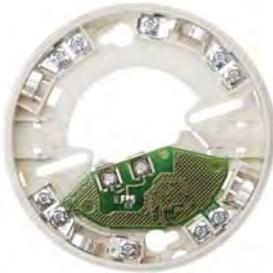
База с релейным выходом для извещателей IQ8Quad. Реле с сухим контактом Н.З. или Н.Р. (выбирается переключкой). Заводская установка: Н.Р. контакт.
