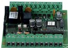
Транспондер esserbus является адресным абонентом аналогово-кольцевого шлейфа. Ко входам транспондера может быть подключено 4 сигнальные линии, предназначенные для подключения пожарных извещателей UniVario. Дополнительно транспондер оснащён двумя свободно программируемыми релейными выходами с функцией контроля линии и встроенным изолятором короткого замыкания.
