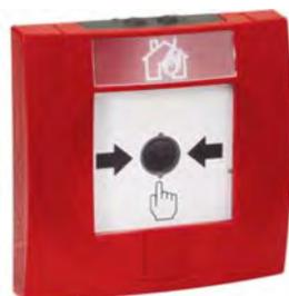
Неадресный взрывобезопасный ручной извещатель типа В, в корпусе накладного монтажа с защитной стеклянной вставкой.
