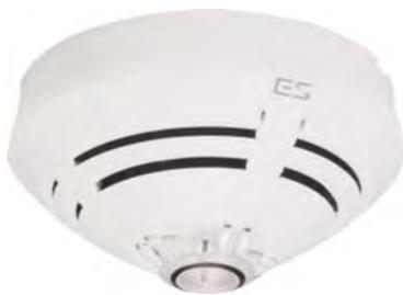
Автоматический извещатель тепла с быстрым полупроводниковым сенсором для обнаружения динамического роста температуры окружающей среды. Встроенный термомаксимальный сенсор для обнаружения пожаров с медленным повышением температуры. Извещатель с децентрализованным интеллектом, автоматическим самотестированием, имеется возможность подключения выносного тревожного индикатора.
