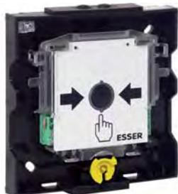
Адресный электронный модуль для подключения к кольцевым шлейфам типов esserbus и esserbus Plus. Фиксация кнопки и индикатор тревоги. Дополнительный вход для подключения шлейфа с неадресными извещателями. При подключении к неадресному шлейфу, работает как неадресный извещатель. Встроенный изолятор короткого замыкания. При отсутствии связи с КП, включается режим аварийной работы.
