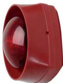
Адресное сигнальное устройство с питанием от шлейфа, соответствующее нормам EN 54-3. 19 программируемых тональных сигналов, включая DIN-тоны (по DIN 33404 часть 3). Громкость может быть выставлена по 8 уровням. Плоский корпус позволяет оптимально адаптировать устройство под дизайн помещения. Корпус выполнен из ударопрочного пластика, устойчивого к царапинам. При использовании баз 806201 и 806202, может быть обеспечена защита от воздействия окружающей среды.
