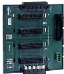
Платформа с соединительными разъёмами для установки до 4 функциональных модулей. Разъёмы для подключения клеммных блоков FX808435 и FX808436 (расположены справа).
