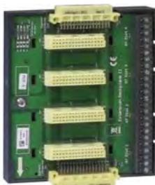
Платформа с соединительными разъёмами для установки до 4 функциональных модулей. При установке, модули автоматически защёлкиваются в слотах и могут заменяться без использования инструментов. При горизонтальной установке платформы, винтовые клеммы подключения расположены снизу, при вертикальной установке - справа.
