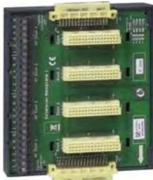
Платформа с соединительными разъёмами для установки до 4 функциональных модулей. При установке, модули автоматически защёлкиваются в слотах и могут заменяться без использования инструментов. При горизонтальной установке платформы, винтовые клеммы подключения расположены сверху, при вертикальной установке - слева.
