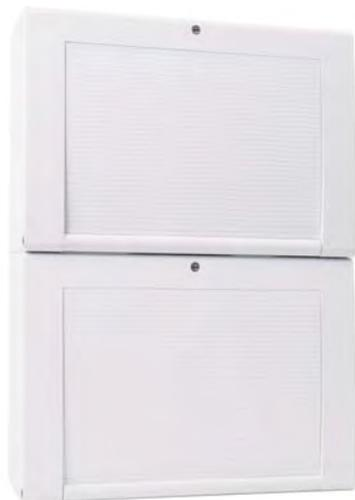
Дополнительный блок питания для расширения мощности встроенного блока питания. В корпусе устанавливается модуль блока питания на 150 Вт, подключаемый к основному блоку питания, а также бокс для установки двух аккумуляторов 12 В / 24 Ач. Для расширения ёмкости аккумуляторов может использоваться ещё один дополнительный корпус FX808313, вмещающий ещё два аккумулятора 12 В / 24 Ач.
