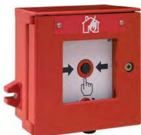
Неадресный ручной извещатель типа В по EN54-11 для установки в помещениях со взрывоопасной атмосферой.
