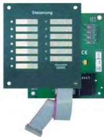
Дополнительная светодиодная панель для индикации активированных релейных выходов и механический счётчик тревог. Плата подключается шинным кабелем к пульту управления и индикации 788400/788401.
