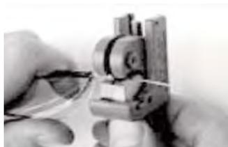
Рекомендуется для резки армированного оптоволоконного кабеля, для правильного удаления оболочки и последующей сварки с пигтейлом.
