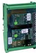
Используется для подключения последовательного интерфейса 784847 к компьютеру.
