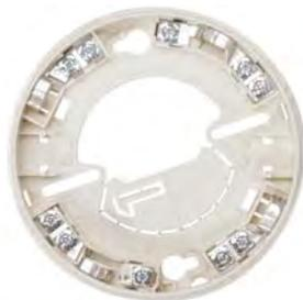
Стандартная база для установки любых извещателей серии IQ8Quad. При извлечении извещателя из базы, шлейф автоматически замыкается. База имеет дополнительный элемент, который может использоваться в случае необходимости, для защиты от несанкционированного снятия извещателя.
