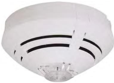
Оптический извещатель для раннего обнаружения пожаров, сопровождающихся выделением светлого дыма. Аналогово-адресный извещатель с децентрализованным интеллектом, автоматическим самотестированием, аварийным режимом, счётчиком тревог и часов наработки, индикатором тревоги/рабочего режима и программной адресацией. Извещатель снабжён встроенным изолятором шлейфа, имеется возможность подключения выносного тревожного индикатора.
