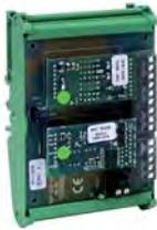
Модуль для подключения системы палатной сигнализации к контрольной панели серии System 8000 / IQ8Control. Панель должна быть также оснащена модулем ADP-N3E (арт.№ 784744). Интерфейс ADP-PRS-422 используется для организации гальванически изолированного интерфейса RS232. Длина кабеля между ADP-PRS-422 и системой палатной сигнализации должна составлять не более 15 м.
