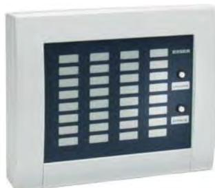
Выносная индикационная панель на 32 сигнала. Сигналы могут свободно программироваться задаваться как для индивидуальных элементов, входов и выходов, так и групп извещателей. Табло работает на основе транспондера esserbus на 32 выхода оптопары и подключается к кольцевому шлейфу типа esserbus или esserbus Plus. Кнопки для тестирования светодиодных индикаторов и сброса встроенного зуммера. Элегантный пластиковый корпус для настенного монтажа.
