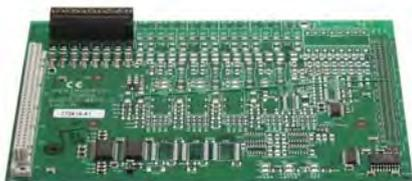
Карта расширения 772478 подключается к разъёму №1 на базовой карте контрольной панели.
