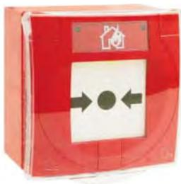
Компактный адресный (esserbus и esserbus Plus) взрывобезопасный ручной извещатель типа А в корпусе, с базой накладного монтажа и откидной прозрачной защитной крышкой.
