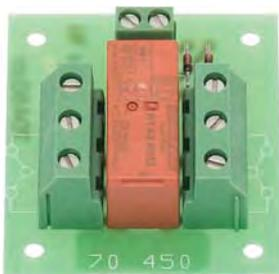
Компактная печатная плата с трёхполюсным реле и клеммами подключения.
