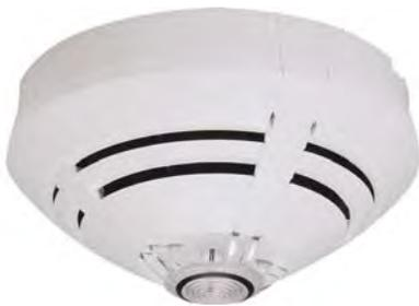
Автоматический извещатель тепла с быстрым полупроводниковым сенсором для обнаружения возгораний, связанных с выделением тепла. Аналогово-адресный извещатель с децентрализованным интеллектом, автоматическим самотестированием, аварийным режимом, счётчиком тревог и часов наработки, индикатором тревоги/рабочего режима и программной адресацией.
