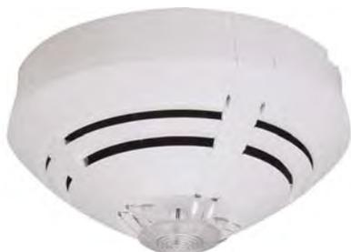
Оптико-тепловой извещатель IQ8Quad для использования в измерительной камере 781443. Извещатель используется для обнаружения как тлеющих возгораний, так и возгораний, сопровождающихся выбросом тепла. Извещатель также способен распознавать мелкие частицы дыма и аэрозольные продукты горения, ранее обнаруживавшиеся только при использовании ионизационных извещателей. Извещатель снабжён встроенным изолятором кольцевого шлейфа.
