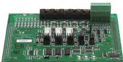
Карта внешних устройств содержит интерфейс для связи с унифицированным пультом управления пожарной бригады, интерфейс передающего устройства и три свободно программируемых реле, контролируемых, с сухими контактами или выдачей потенциала до 24В. Карта внешних устройств может быть подключена только разъёму №1 базовой карты КП.
