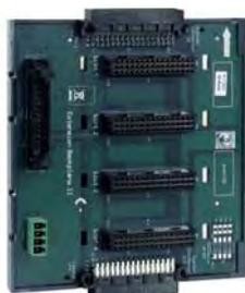
Платформа с соединительными разъёмами для установки до 4 функциональных модулей. Разъёмы для подключения клеммных блоков FX808435 и FX808436 (расположены слева).
