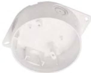
Адаптер накладного монтажа для защиты от влаги, с возможностью установки трёх резьбовыми гермовводов диаметром 20 мм (в комплекте не поставляются). Предусмотрена защита от накопления и конденсации влаги внутри адаптера. Для защиты от конденсата применяется уплотнение.
